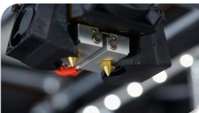
La **Raise3D Pro2 Plus** est munie d'un système de **double extrusion**, vous permettant d'imprimer des pièces mécaniques et complexes en multi-matériaux et multi couleurs. Cette machine est également équipée d'un système électronique d'auto-élévation des buses, cela veut dire qu'une buse qui n'imprime pas s'élève de 1.5 mm afin d'éviter de déranger l'extrusion de l'autre buse qui est en cours fonctionnement. La durée d'échange des buses est inférieure à 1 seconde.
