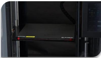
Ce nouveau système de **plateau d'impression** est recouvert d'une surface d'impression en silicone permettant une excellente **prévention du warping**. De bonne qualité, il garantit une répartition égale de la chaleur sur toute la plateforme. La calibration automatique se réalise sur 4 ou 9 points.
