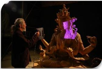
**Le scan HD à la main** : Le mode scan HD à la main vous permet de réaliser des scans 3D avec une haute précision de 50 microns.
